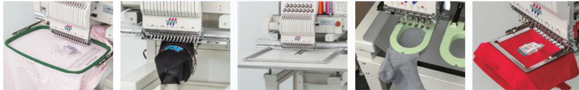
▲袋物枠 (標準)    ▲ワイド帽子枠    ▲原反枠    ▲靴下枠    ▲エア式クランプ枠
